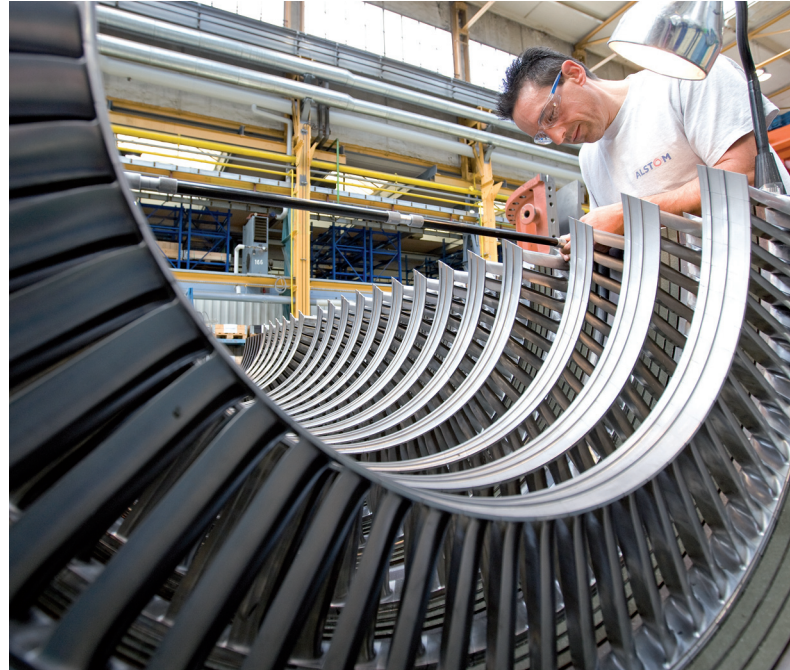
Auf den Hundertstelmillimeter genau: Roland Lembo an einem Bauteil der Hochdruckturbine.
