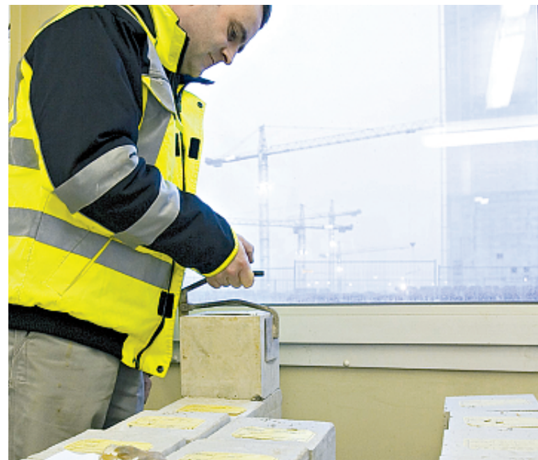
Genormte Probewürfel: Betonprüfer Bernd Neubert
