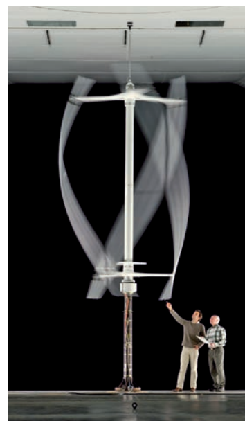
Tests im Windtunnel im National Research Council, Kanada
