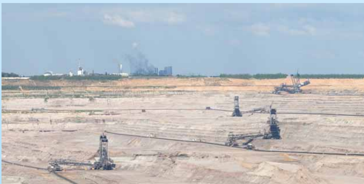
Der Tagebau Hambach ist einer der drei rheinischen Braunkohlentagebaue: Seine Schaufelradbagger gewinnen jährlich bis zu 45 Millionen Tonnen Kohle für die Stromerzeugung und die Veredlung vor allem zu festen Brennstoffen.
