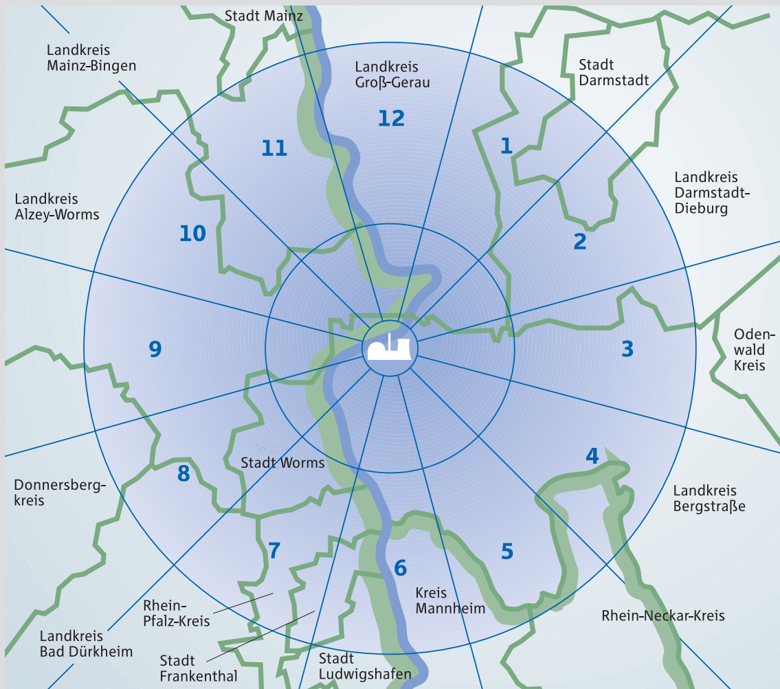
Umgebung des Kernkraftwerks Biblis: Die Mittel- und Außenzone sind in 30-Grad-Sektoren (1 bis 12) unterteilt.
