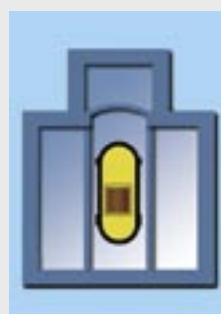
Sicherheitsbehälter aus Spannbeton mit Stahlhaut
