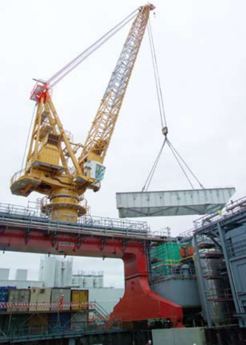
Bis Ende 2005 wurden auf der Insel Mittelplate zahlreiche Anlagen und Einrichtungen ausgebaut, optimiert oder erneuert. Dazu gehört auch ein leistungsstarker neuer Portal Kran, dessen Schwenkbereich alle Transportanforderungen auf der gesamten Insel abdeckt.
