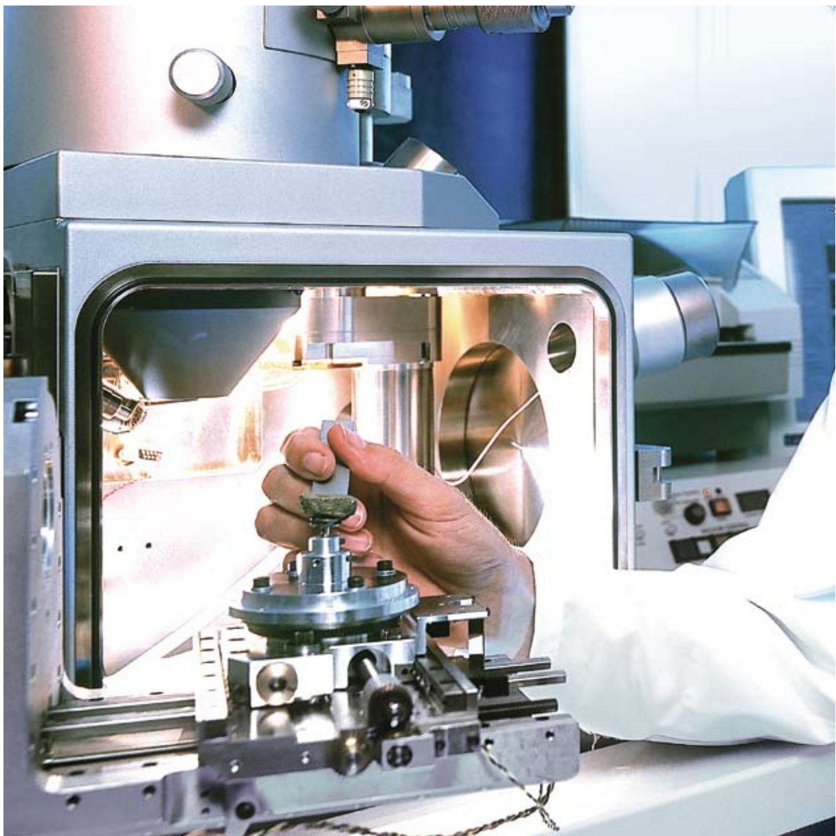
Im RWE Dea-Labor wird eine Probe zur Untersuchung mit dem Rasterelektronenmikroskop vorbereitet.
