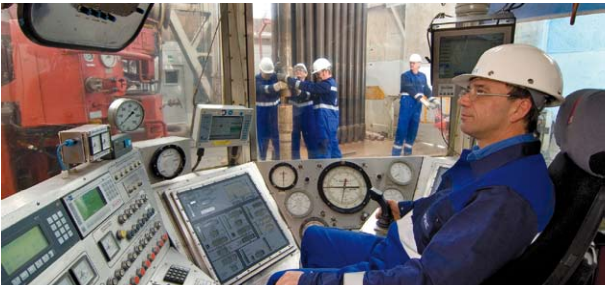
Im Leitstand der Bohranlage T-160: Von hieraus wird der Bohrmeißel punktgenau in die Lagerstätte gesteuert.
