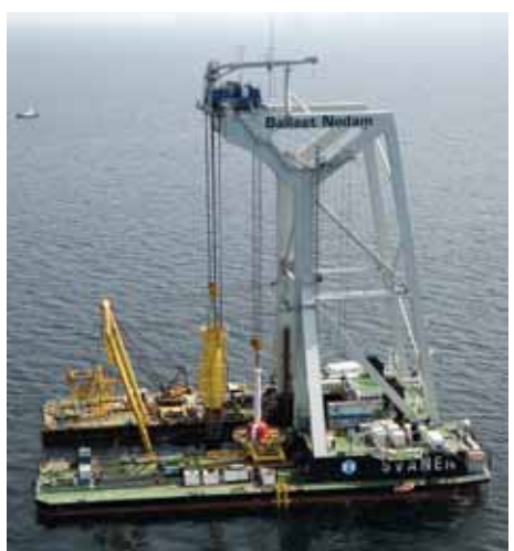
(Lluniau uchod) Mi fydd HLV Svanen yn gosod sylfeini Fferm Wynt Alltraeth Gwastadeddau Rhyl.
