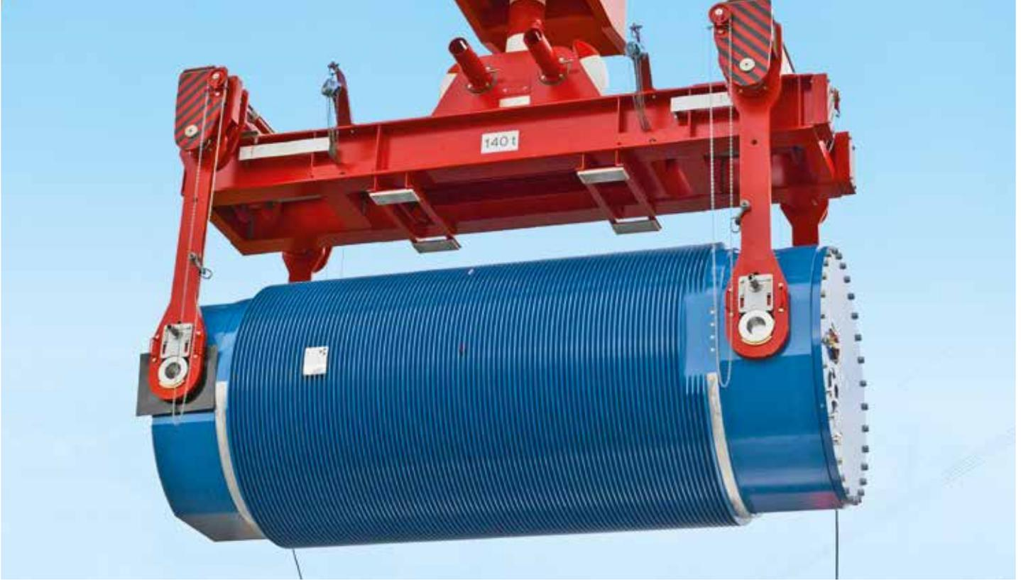
↑ **CASTOR AM HAKEN:** Auf diesem Weg wird der Behälter zur Beladung mit abgebrannten Brennelementen in Block B transportiert.
