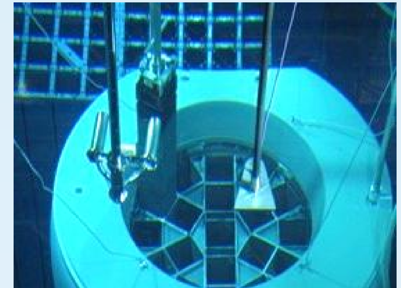
Brennelemente im CASTOR®-Behälter
