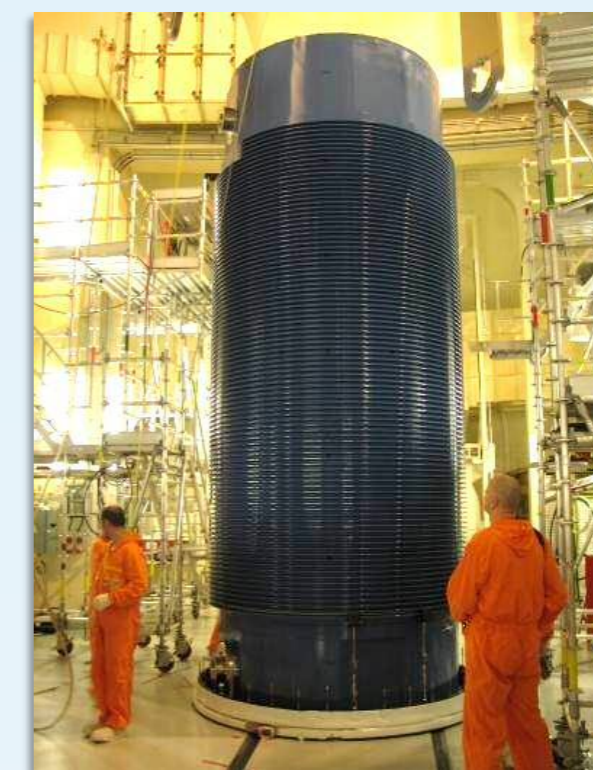
Abfertigung des CASTOR®-Behälters im Block
