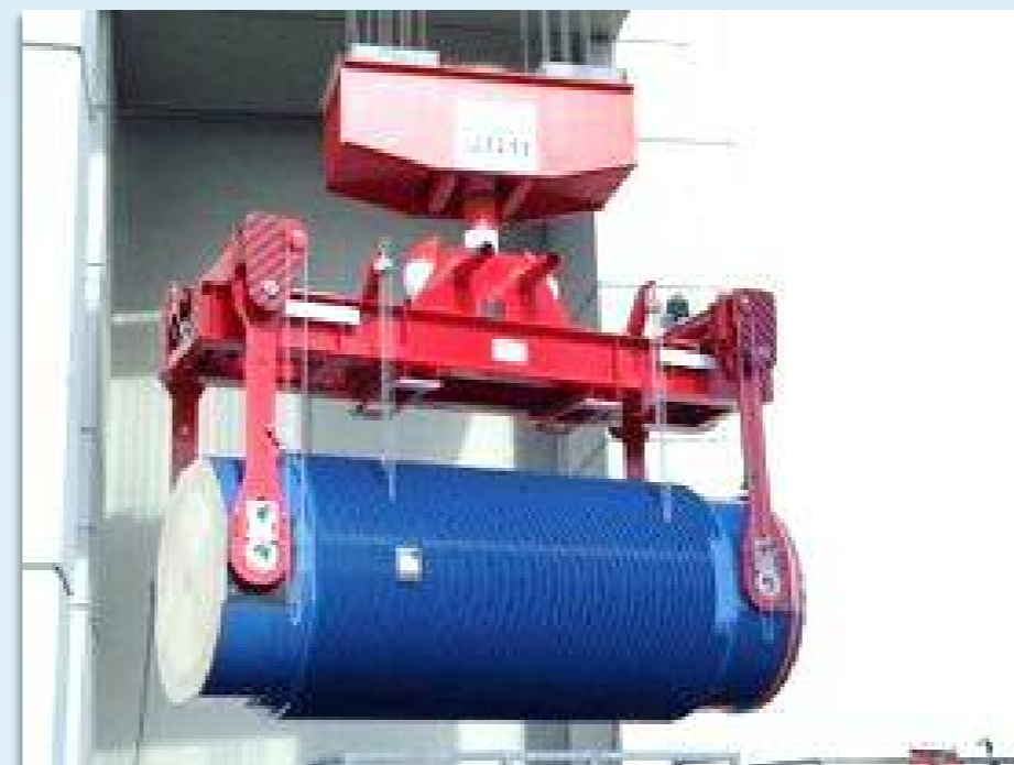
Einschleusen in das Reaktorgebäude
