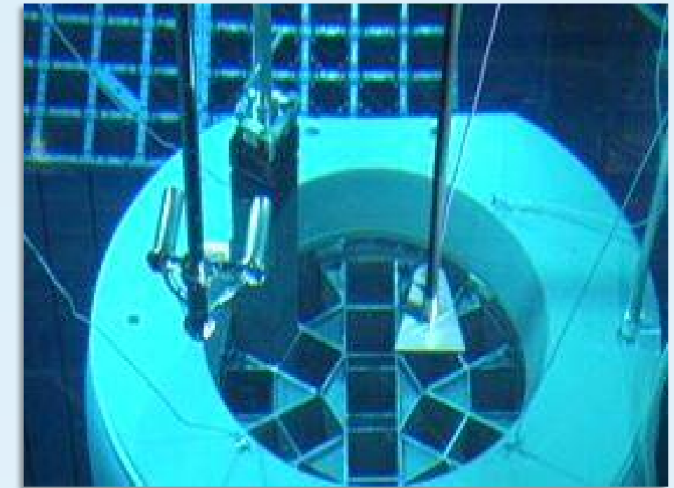
Brennelemente im CASTOR®-Behälter
