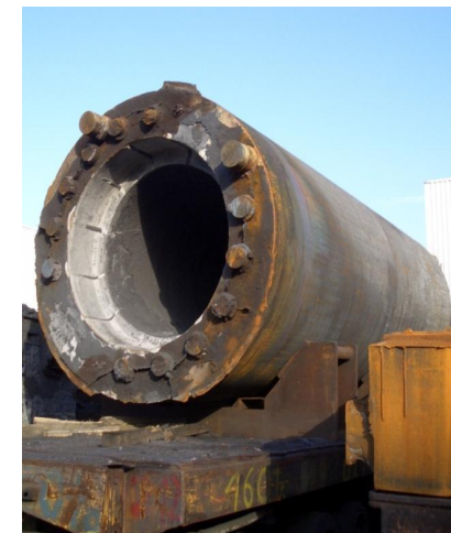
Behälterkörper aus einem Guss
