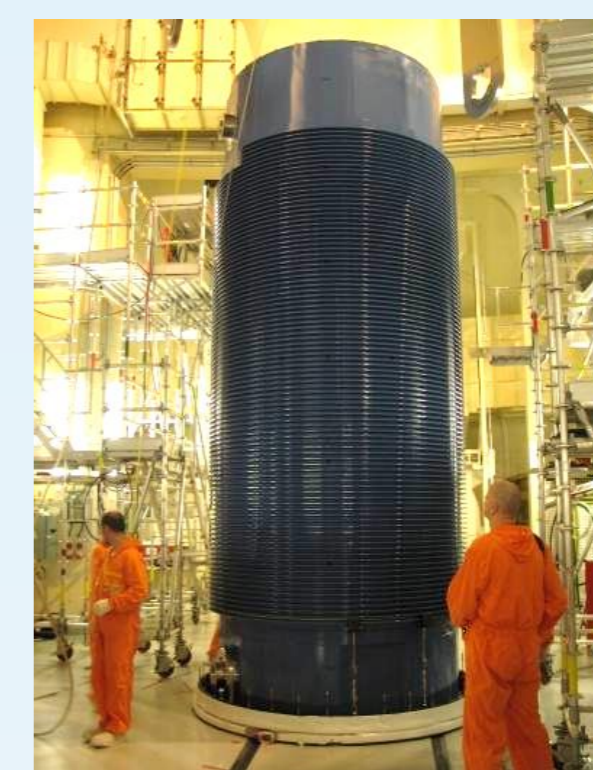
Abfertigung des CASTOR®-Behälters im Block
