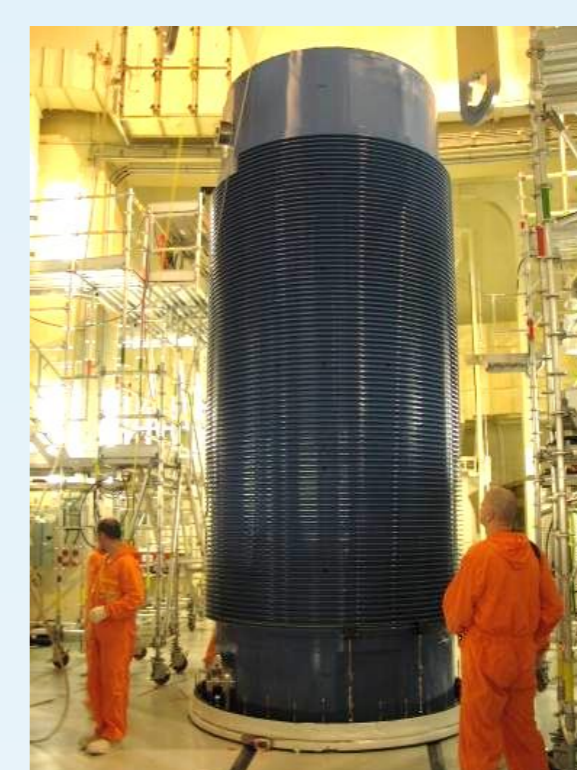
Abfertigung des CASTOR®-Behälters im Block
