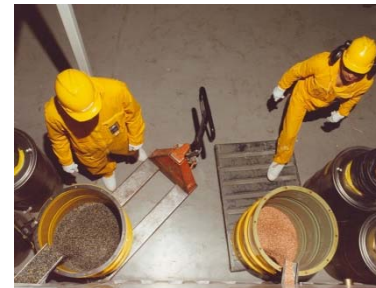
Dekontamination von Elektrokabeln durch Trennung von Kupfer und Isolierung
