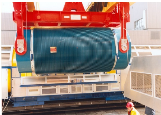
Ausschleusen aus dem Reaktorgebäude
