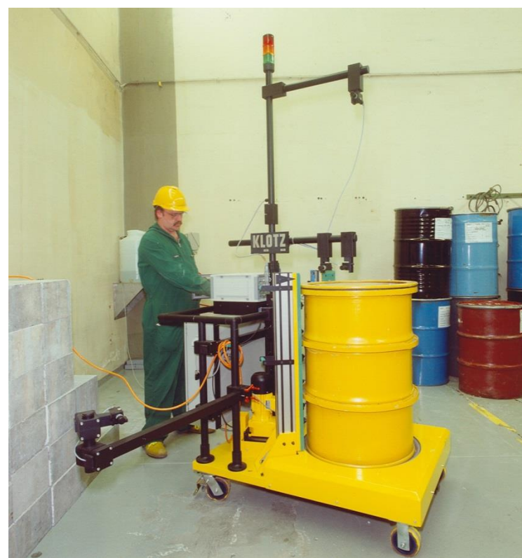
Anlage zur Messung radioaktiver Abfälle
