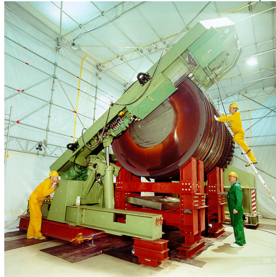
Großbandsäge - Zerlegen eines Turbinenläufers
