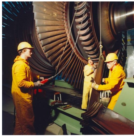
Entschaufeln einer Turbine
