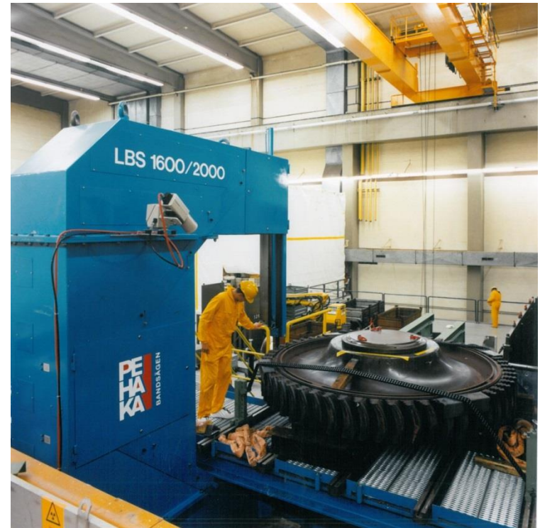
Großbandsäge - Zerlegen einer Radscheibe
