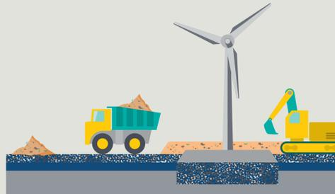
**4.7 Überschüttung** des fertigen Fundaments mit zuvor gelagertem Bodenaushub
