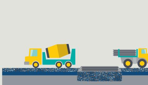
**4.5 Errichtung** der **Fundamentform** mithilfe von Schaltafeln, Einbau von Stahl und Betonguss
