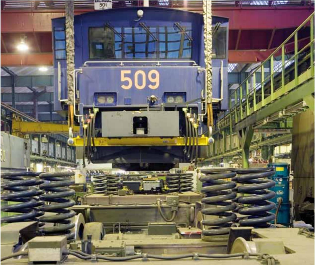
Fahrwerksmontage einer Schwerlastlokomotive TT/HW
