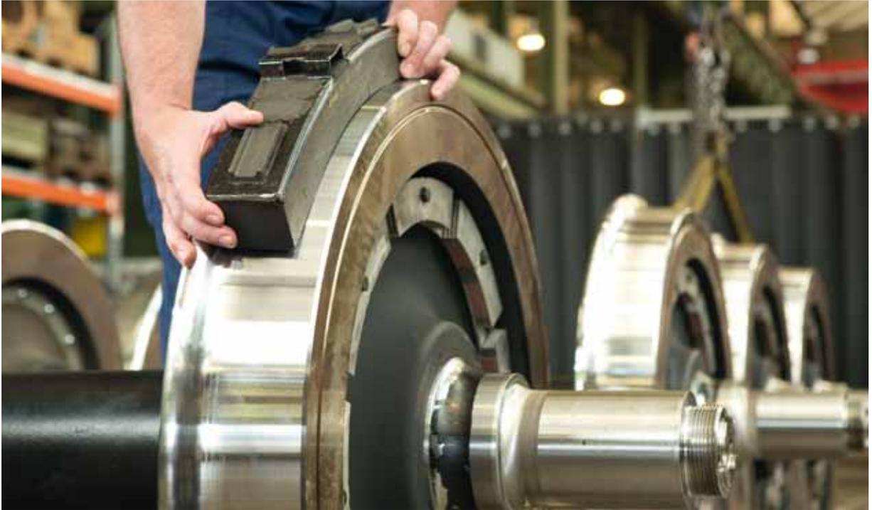
Reprofilerte Radsätze mit Bremsklotzsohle aus Verbundwerkstoff
