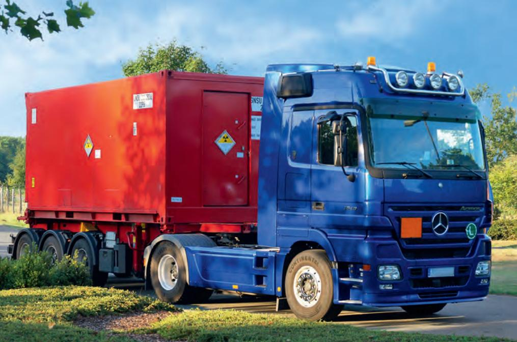
↑ BEHUTSAM: Der Spezial-Lkw bringt einen 20-Fuß-Container, gefüllt mit schwach- und mittelradioaktiven Abfällen, aus dem Kernkraftwerk in ein Zwischenlager.
