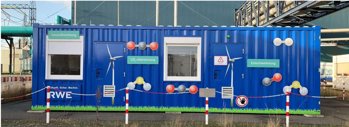
Im Container sind die Testapparaturen, die Online-Analytik sowie die Prozessleittechnik untergebracht. Der Container kann per Tieflader transportiert werden und wird in 2021 im Rahmen von mehreren öffentlich geförderten Projekten an der TU Darmstadt eingesetzt.
